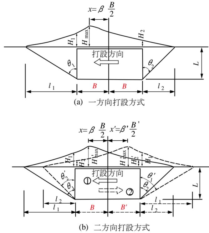
$H_1$ 又は $H_2$ と $H_{max}$ の比である $\alpha_1$ 又は $\alpha_2$ 、 $x$ と $B/2$ の比 $\beta$ 並びに盛り上り範囲の発生角度 $\theta_1$ 及び $\theta_2$ を用いると、
