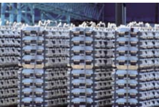
溶かしたアルミニウムを型に流し込んで固めたアルミインゴット。富山県内で取り扱われるアルミニウムの量は、全国のおよそ4割を占める。
