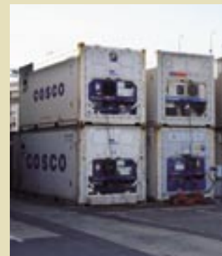
内部温度を一定に保つことができ、生鮮食料品などの輸送に多用されているリーファーコンテナ。
