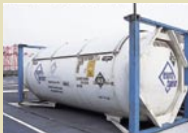
石油や薬品などをはじめ、ワインやジュースなどの飲料の輸送に利用されるタンクコンテナ。(撮影/相澤正)
