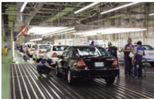
ダイムラー・クライスラー日本の豊橋新車整備センター。洗車を終えた車体はスタッフによって、内外装・機能点検に入る。
