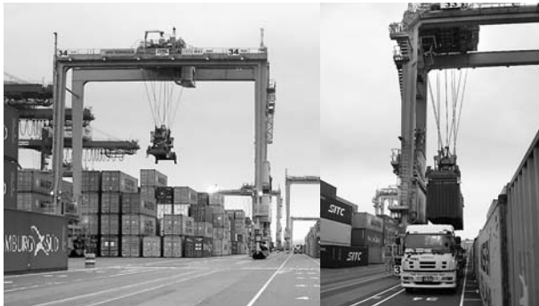
RTGによるコンテナの積卸しの様子（横浜港南本牧ふ頭）
