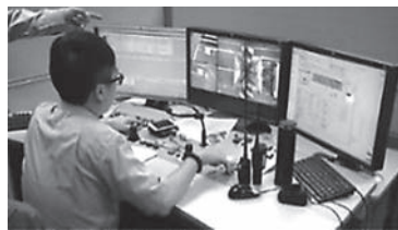
管理棟からRTGを遠隔操作
