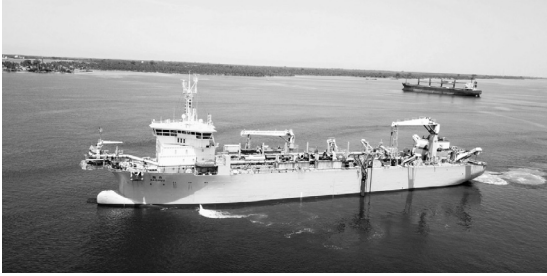
写真1 TSHD「海舟」浚渫状況
