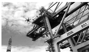
UAVsのリモート操作でのクレーン検査
