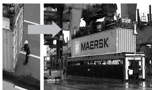
自動コンテナロック・アンロック装置 パシルパンジャンターミナルにおける自動化等の取り組み (出典：MPA提供資料)
