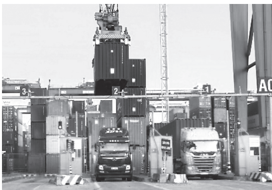
写真1 ARMGから外来シャーシへの積み込みの様子
