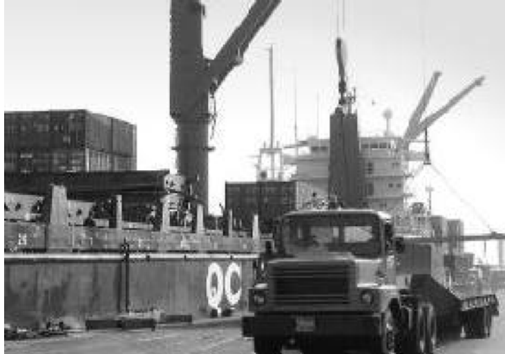
チッタゴン港における船載クレーンによる荷役
