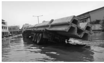
写真1 コンクリート矢板運搬トレーラーの道路上スタック
