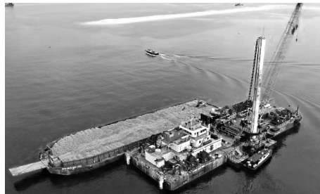
写真4 捨石マウンド構築専用台船“Petra One”
