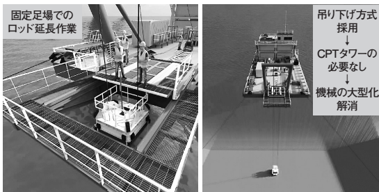
図2 専用台船“Sherlock”採用による問題点の解消
