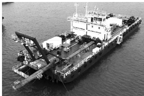
写真3 海上CPT専用台船 "Sherlock"
