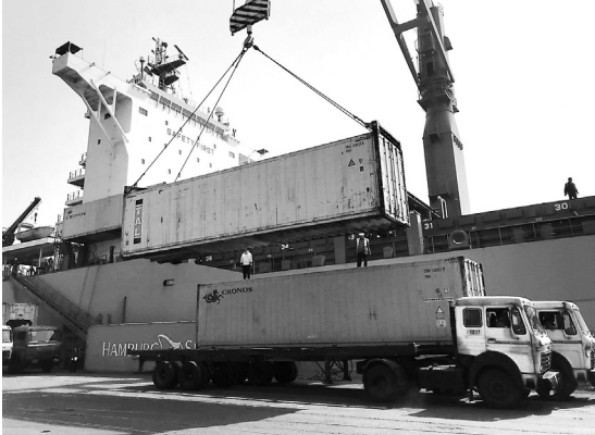
図2 バース・オペレータ手配の労働力（船内荷役、沿岸荷役）とシップギアで本船荷役
