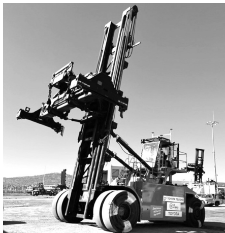
水素燃料電池が搭載されたトップハンドラー
