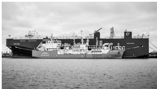
Ship to ShipによるLNGバンカリングの様子 日本郵船(株)HPより
