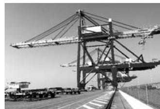
Euromaxのダブルトロリ方式 Quay Crane
