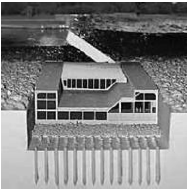
図3 フラップ式水門の構造概要
