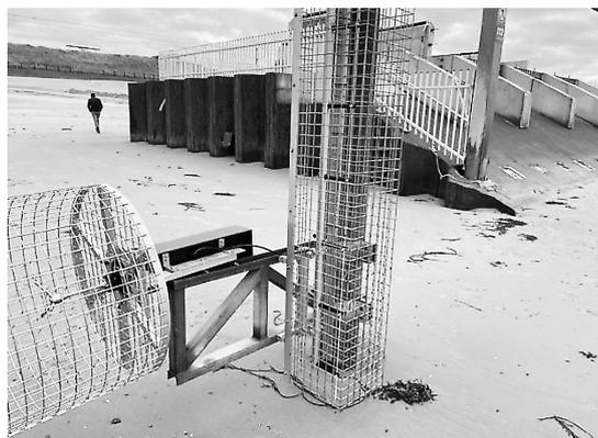
図3 越波観測施設（写真奥）と流速計等の観測装置（同手前）
