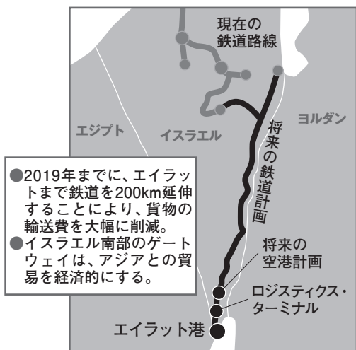
図1 エイラット港への連絡鉄道
