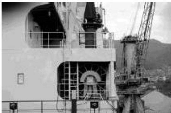
陸上電源設備 (AMP) 本船側設備 (建造中の本船 NYK ATLAS 船首側から見たブリッジ上の電源コードリール)
