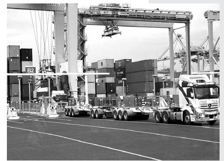
図5 ASCによる陸側荷役 (VICT)
